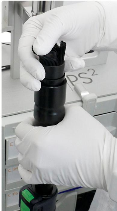
Bürstensaugdüse mechanisch vorreinigen
