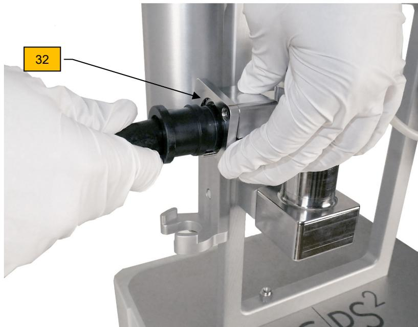
Saugschlauch (1 oder 2 m) anschließen
