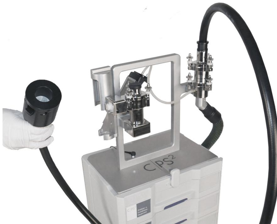
Blindwertermittlung, Absaugung mit Vorfilter
