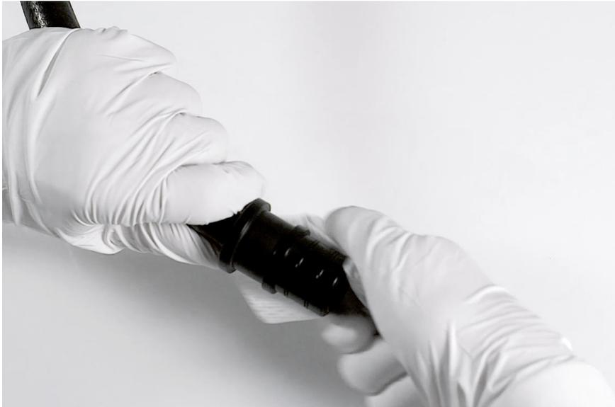
Reinigung der Steckbuchsen an den Schlauchenden
