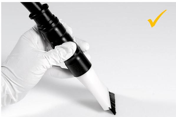
Korrektes Aufsetzen der Flachdüse
