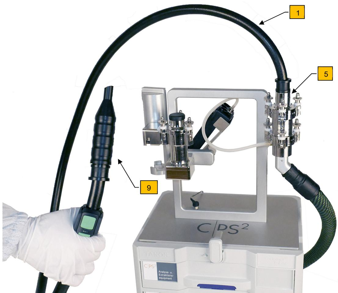
Saugschlauch anschließen und Saugdüse aufstecken
